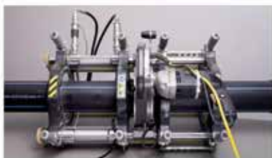
Broyer les pièces à souder et vérifier l'alignement.
