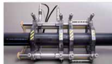
Broyer les pièces à souder et vérifier l'alignement.
