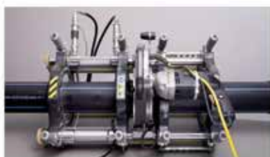
Fresar las partes a soldar y verificar la alineación.
