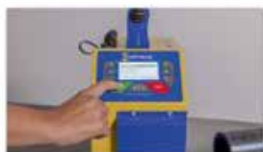
Iniciar la soldadura. Realizar los controles necesarios (alineación, profundidad de inserción e indicadores de fusión).
