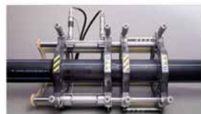
Fresar las partes a soldar y verificar la alineación.
